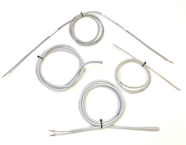
Topné kabely jsou flexibilní a velmi odolné. Elektrická izolace je zhotovena z PVC nebo – pro vyšší zatížení – ze silikonu. Volitelné kovové opletení zvýší mechanickou a elektrickou odolnost.
