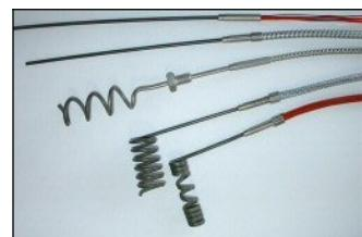
Typicky se přímé topné kabely používají pro svařovací lišty; stočené do cívky se používají pro ohřev vstřikovacích trysek při zpracování plastů. Při vyšších náročích na výkon nebo homogenitu rozložení teplot mohou být závit v hliníku nebo v bronzu. Topné kabely **FC** s větším průřezem (např.  $6,1 \times 6,1$ ) se používají pro ohřev lisovacích forem.
